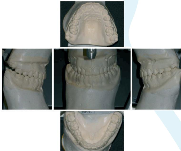
Fig. 17— Modelos finais montados no articulador em RC.
